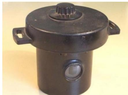
Figura VII. Galvanómetro de resonancia para corriente alterna (Laboratorio de UTE)
