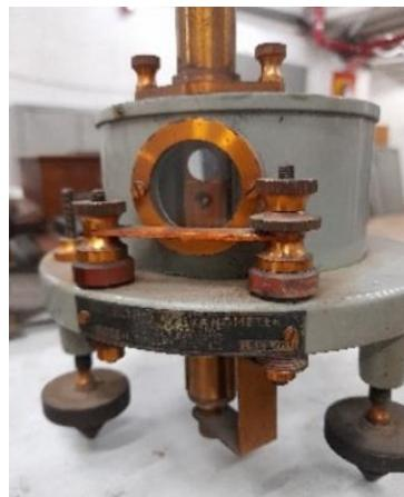
Figura VI. Sistema móvil de galvanómetro de alta sensibilidad (Laboratorio de UTE).
