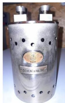
Figura IX. Patrón de resistencia fechado en 1907 (Laboratorio de UTE).
