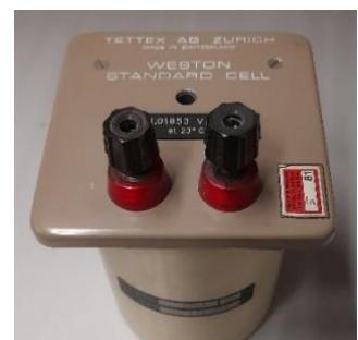
*Figura XXV. Pila patrón tipo Weston (Laboratorio de UTE).*
