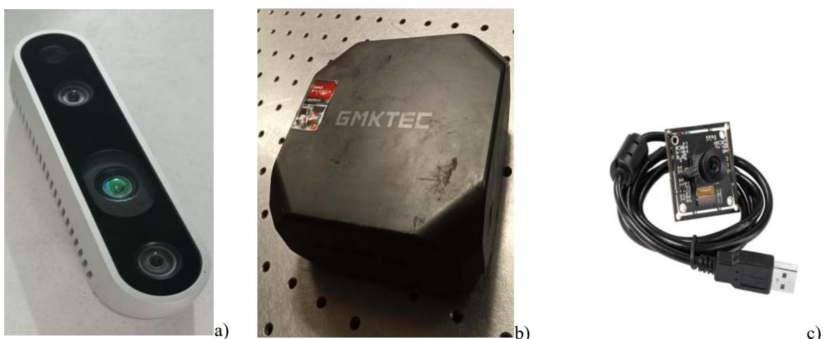
Figura VI. Principales componentes del sistema a) cámara de profundidad que combina sensores IR, una cámara RGB de alta resolución y una unidad de medición inercial (IMU) para capturar datos tridimensionales. b) muestra una computadora GMXTEC con un procesador AMD Ryzen 7 3750H y 16 GB DDR4 con un sistema operativo Linux.
