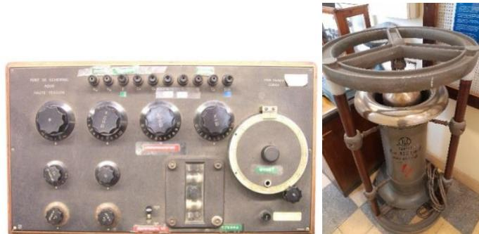
Figura XXVII. Puente Schering de la marca Trüb-Täuber y capacitor patrón de alta tensión (Laboratorio de UTE).
