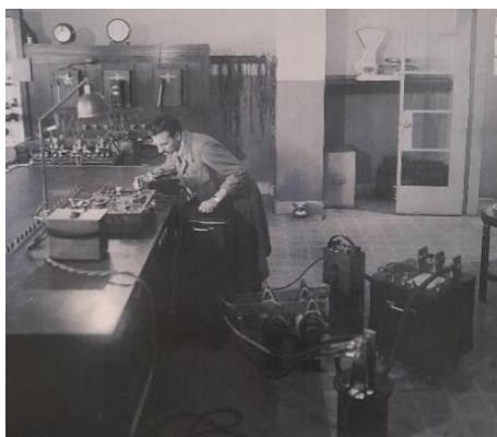
*Figura XXI. Sala de calibración de transformadores de medida del Laboratorio de UTE. Década de 1940.*
