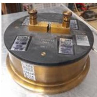
Figura XXVI. Patrón de capacidad de 1  $\mu\text{F}$  (Laboratorio de UTE).
