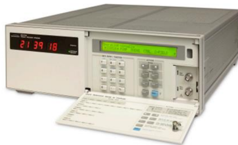
Figura XIII. Equipo patrón de Cesio de LABUTE [13].
