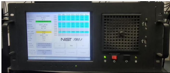
Figura XV.- Equipo de LABUTE para medida y envío de reportes a la UTC.
