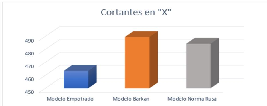
Figura XIII. Comparación de las fuerzas cortantes con los modelos dinámicos en "X"
