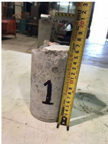
Figura XXV. Ensaye de 1er espécimen dando una resistencia de 174.42 kg/cm 2
