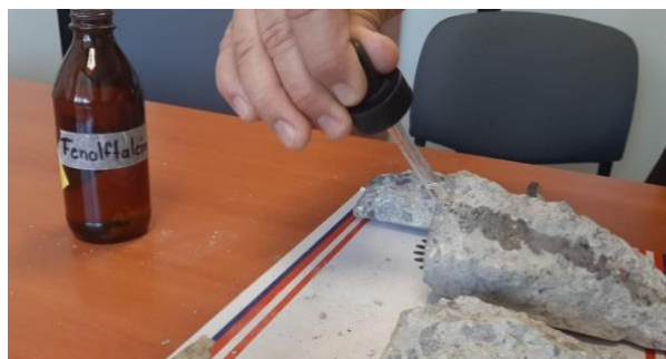
Figura IX. Aplicación de fenolftaleína al 1% en alcohol en muestras de concreto.
