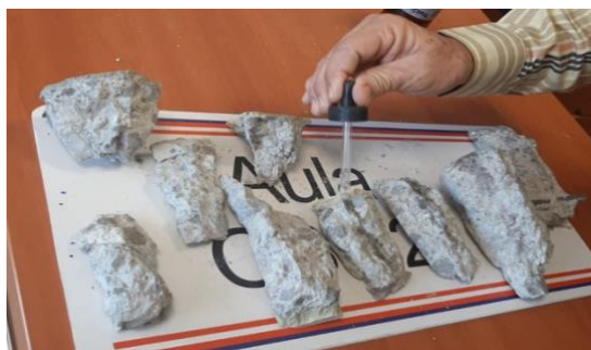
Figura IX. Aplicación de fenolftaleína al 1% en alcohol en muestras de concreto.
