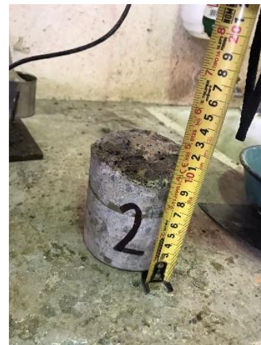
Figura XXVI. Ensaye de 2do espécimen dando una resistencia de 137.35 kg/cm 2
